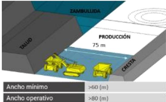
Figura 5 Working Room en Zona de Producción
